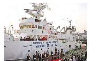
総トン数256トン、全長40.5m。推進システムは全旋回式縦軸型推進機による電気推進
